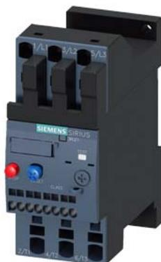
relè di sovraccarico 14...20 A termico per protezione motore grandezza costruttiva S0, CLASS 10 montaggio separato circuito principale: morsetto a molla circuito ausiliario: morsetti a molla reset manuale-automatico
