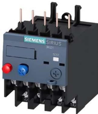
relè di sovraccarico 11...16 A termico per protezione motore grandezza costruttiva S00, CLASS 10 montaggio su contattore circuito principale: capocorda circuito ausiliario: capocorda a occhiello reset manuale-automatico
