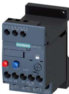
relè di sovraccarico 4,5...6,3 A termico per protezione motore grandezza costruttiva S00, CLASS 10 montaggio separato circuito principale: morsetti a vite circuito ausiliario: morsetti a vite reset manuale-automatico
