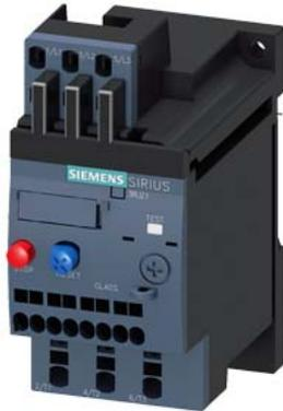
relè di sovraccarico 2,8...4,0 A termico per protezione motore grandezza costruttiva S00, CLASS 10 montaggio separato circuito principale: morsetto a molla circuito ausiliario: morsetti a molla reset manuale-automatico
