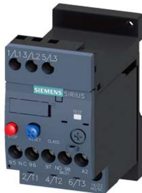
relè di sovraccarico 2,8...4,0 A termico per protezione motore grandezza costruttiva S00, CLASS 10 montaggio separato circuito principale: morsetti a vite circuito ausiliario: morsetti a vite reset manuale-automatico
