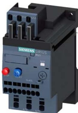
relè di sovraccarico 0,35...0,50 A termico per protezione motore grandezza costruttiva S00, CLASS 10 montaggio separato circuito principale: morsetto a molla circuito ausiliario: morsetti a molla reset manuale-automatico
