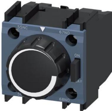
bloccetto di contatti ausiliari ritardato pneumaticamente , ritardato all'eccitazione, 10...180 s, 1 NO + 1 NC, per il montaggio sui contattori 3RT202
