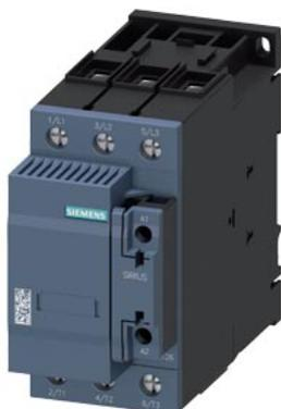
contattore per condensatore, AC-6b 75 kVA<sub>r</sub>, / 400 V, a 3 poli, AC 230 V, 50/60 Hz, contatti ausiliari: 1 NO + 1 NC, morsetti a vite, grandezza costruttiva: S2
