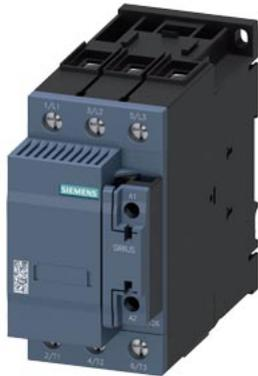
contattore per condensatore, AC-6b 50 kVA<sub>r</sub>, / 400 V, a 3 poli, AC 230 V, 50/60 Hz, contatti ausiliari: 1 NO + 1 NC, morsetti a vite, grandezza costruttiva: S2
