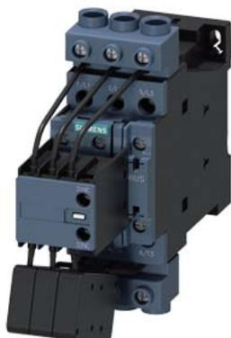
contattore per condensatore, AC-6b 33 kVA<sub>r</sub>, / 400 V, a 3 poli, AC/DC 21...28 V, 50/60 Hz, con varistore integrato, contatti ausiliari: 1 NO + 2 NC, morsetti a vite, grandezza costruttiva: S0
