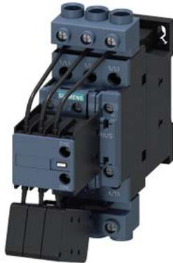
contattore per condensatore, AC-6b 33 kVA<sub>r</sub>, / 400 V, a 3 poli, AC 110 V, 50 Hz, contatti ausiliari: 1 NO + 2 NC, morsetti a vite, grandezza costruttiva: S0
