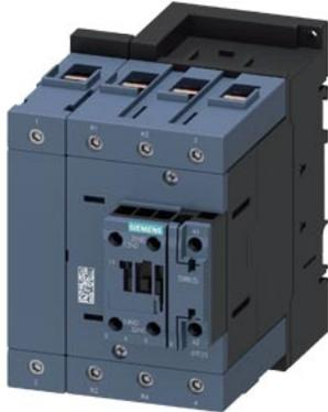
contattore di potenza, AC-3, 80 A, 37 kW / 400 V, a 4 poli, AC 110 V, 50 Hz / 120 V, 60 Hz, contatti principali: 2 NO + 2 NC, contatti ausiliari: 1 NO + 1 NC, morsetti a vite, grandezza costruttiva: S3
