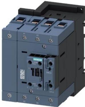
contattore di potenza, AC-3, 80 A, 37 kW / 400 V, a 4 poli, AC 24 V, 50 Hz, contatti principali: 2 NO + 2 NC, contatti ausiliari: 1 NO + 1 NC, morsetti a vite, grandezza costruttiva: S3
