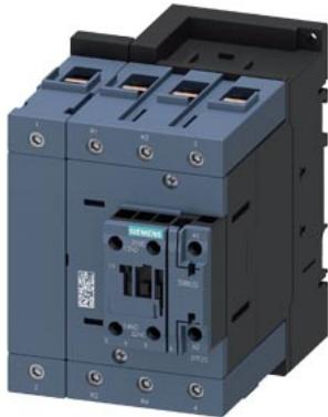
contattore di potenza, AC-3, 65 A, 30 kW / 400 V, a 4 poli, AC/DC 20...33 V, 50/60 Hz, con varistore integrato, contatti principali: 2 NO + 2 NC, contatti ausiliari: 1 NO + 1 NC, morsetti a vite, grandezza costruttiva: S3
