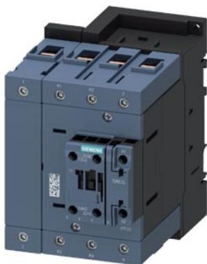
contattore di potenza, AC-3, 65 A, 30 kW / 400 V, a 4 poli, AC 110 V, 50 Hz, contatti principali: 2 NO + 2 NC, contatti ausiliari: 1 NO + 1 NC, morsetti a vite, grandezza costruttiva: S3
