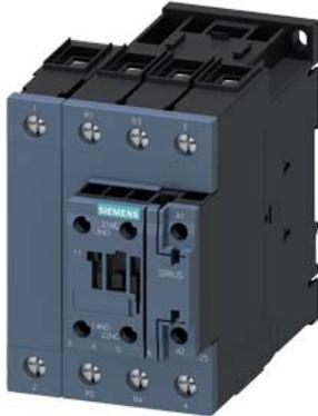
contattore di potenza, AC-3, 41 A, 22 kW / 400 V, a 4 poli, AC/DC 20...33 V, 50/60 Hz, con varistore integrato, contatti principali: 2 NO + 2 NC, contatti ausiliari: 1 NO + 1 NC, morsetti a vite, grandezza costruttiva: S2
