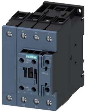
contattore di potenza, AC-3, 41 A, 22 kW / 400 V, a 4 poli, AC 24 V, 50/60 Hz, contatti principali: 2 NO + 2 NC, contatti ausiliari: 1 NO + 1 NC, morsetti a vite, grandezza costruttiva: S2
