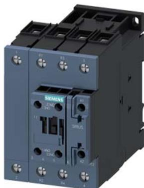
contattore di potenza, AC-3, 35 A, 18,5 kW / 400 V, a 4 poli, AC 230 V, 50 Hz, contatti principali: 2 NO + 2 NC, contatti ausiliari: 1 NO + 1 NC, morsetti a vite, grandezza costruttiva: S2
