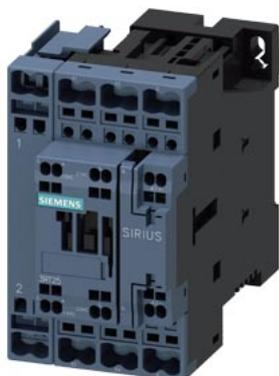
contattore ferroviario, AC-3, 25 A, 11 kW / 400 V, a 4 poli, DC 72 V, 0,7...1,25\* US, comando elettronico, con varistore integrato, contatti principali: 2 NO + 2 NC, contatti ausiliari: 1 NO + 1 NC, morsetti a molla, grandezza costruttiva: S0
