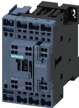
contattore di potenza, AC-3, 25 A, 11 kW / 400 V, a 4 poli, AC/DC 83...155 V, 50/60 Hz, con varistore integrato, contatti principali: 2 NO + 2 NC, contatti ausiliari: 1 NO + 1 NC, morsetti a molla, grandezza costruttiva: S0
