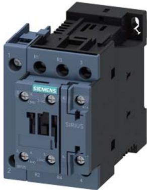
contattore di potenza, AC-3, 25 A, 11 kW / 400 V, a 4 poli, DC 72 V, contatti principali: 2 NO + 2 NC, contatti ausiliari: 1 NO + 1 NC, morsetti a vite, grandezza costruttiva: S0
