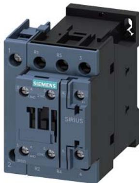
contattore di potenza, AC-3, 25 A, 11 kW / 400 V, a 4 poli, AC 48 V, 50/60 Hz, contatti principali: 2 NO + 2 NC, contatti ausiliari: 1 NO + 1 NC, morsetti a vite, grandezza costruttiva: S0
