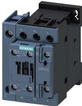
contattore di potenza, AC-3, 25 A, 11 kW / 400 V, a 4 poli, AC 24 V, 50/60 Hz, contatti principali: 2 NO + 2 NC, contatti ausiliari: 1 NO + 1 NC, morsetti a vite, grandezza costruttiva: S0
