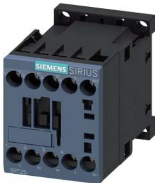
contattore di potenza, AC-3, 12 A, 5,5 kW / 400 V, a 4 poli, DC 48 V, contatti principali: 2 NO + 2 NC, morsetti a vite, grandezza costruttiva: S00
