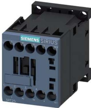
contattore di potenza, AC-3, 12 A, 5,5 kW / 400 V, a 4 poli, DC 60 V, contatti principali: 2 NO + 2 NC, morsetti a vite, grandezza costruttiva: S00
