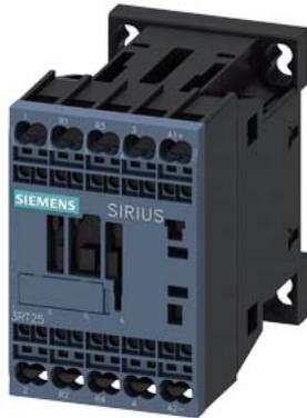
contattore di potenza, AC-3, 9 A, 4 kW / 400 V, a 4 poli, DC 12 V, contatti principali: 2 NO + 2 NC, morsetti a molla, grandezza costruttiva: S00
