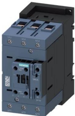
contattore AC-1, 160 A, 690 V / 40 °C, a 3 poli, AC/DC 175...280 V, 50/60 Hz, con varistore integrato, contatti ausiliari: 1 NO + 1 NC, circuito principale: morsetto serracavo, circuito di comando e circuito ausiliario: morsetti a vite grandezza costruttiva: S3
