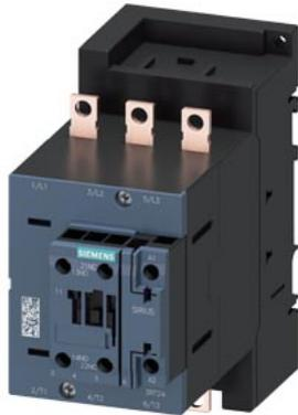
contattore AC-1, 140 A, 690 V / 40 °C, a 3 poli, AC/DC 20...33 V, 50/60 Hz, con varistore integrato, contatti ausiliari: 1 NO + 1 NC, circuito principale: senza morsetto serracavo, circuito di comando e circuito ausiliario: morsetti a vite, grandezza costruttiva: S3
