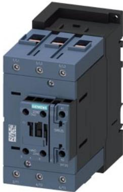
contattore AC-1, 140 A, 690 V / 40 °C, a 3 poli, AC 220 V, 50 Hz / 240 V, 60 Hz, contatti ausiliari: 1 NO + 1 NC, circuito principale: morsetto serracavo, circuito di comando e circuito ausiliario: morsetti a vite, grandezza costruttiva: S3
