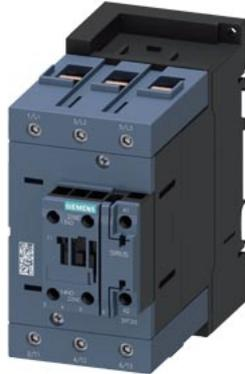
contattore AC-1, 140 A, 690 V / 40 °C, a 3 poli, AC 110 V, 50 Hz, contatti ausiliari: 1 NO + 1 NC, circuito principale: morsetto serracavo, circuito di comando e circuito ausiliario: morsetti a vite, grandezza costruttiva: S3
