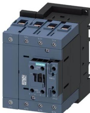
contattore AC-1, 160 A, 400 V / 40 °C, a 4 poli, AC/DC 175...280 V, 50/60 Hz, con varistore integrato, contatti ausiliari: 1 NO + 1 NC, morsetti a vite, grandezza costruttiva: S3
