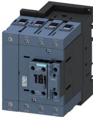
contattore AC-1, 160 A, 400 V / 40 °C, a 4 poli, AC 110 V, 50 Hz, contatti ausiliari: 1 NO + 1 NC, morsetti a vite, grandezza costruttiva: S3
