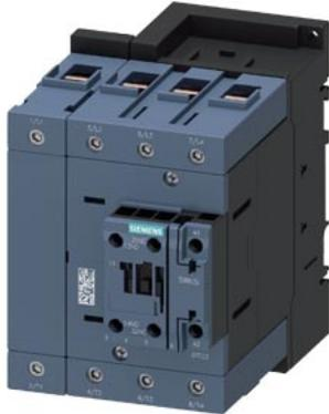
contattore AC-1, 140 A, 400 V / 40 °C, a 4 poli, AC/DC 20...33 V, 50/60 Hz, con varistore integrato, contatti ausiliari: 1 NO + 1 NC, morsetti a vite, grandezza costruttiva: S3
