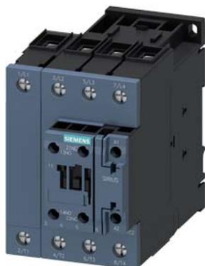
contattore AC-1, 110 A, 400 V / 40 °C, a 4 poli, AC 220 V, 50 Hz / 240 V, 60 Hz, contatti ausiliari: 1 NO + 1 NC, morsetti a vite, grandezza costruttiva: S2
