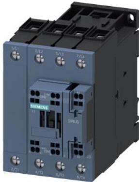
contattore ferroviario, AC-1, 60 A, 400 V / 40 °C, a 4 poli, DC 24 V, 0,7...1,25\* US, comando elettronico, con varistore integrato, contatti ausiliari: 1 NO + 1 NC, circuito principale: morsetti a vite, circuito di comando e circuito ausiliario: morsetti a molla, grandezza costruttiva: S2
