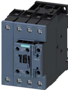
contattore AC-1, 60 A, 400 V / 40 °C, a 4 poli, AC/DC 48...80 V, 50/60 Hz, con varistore integrato, contatti ausiliari: 1 NO + 1 NC, morsetti a vite, grandezza costruttiva: S2
