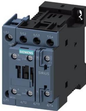
contattore AC-1, 50 A, 400 V / 40 °C, a 4 poli, DC 12 V, contatti ausiliari: 1 NO + 1 NC, morsetti a vite, grandezza costruttiva: S0
