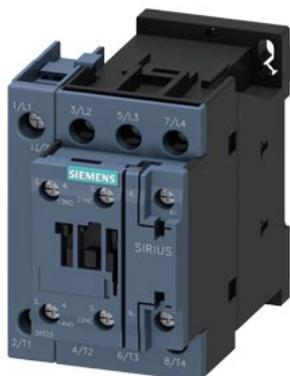
contattore AC-1, 50 A, 400 V / 40 °C, a 4 poli, AC 24 V, 50 Hz, contatti ausiliari: 1 NO + 1 NC, morsetti a vite, grandezza costruttiva: S0
