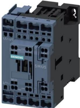
contattore ferroviario, AC-1, 40 A, 400 V / 40 °C, a 4 poli, DC 24 V, 0,7...1,25\* US, comando elettronico, con varistore integrato, contatti ausiliari: 1 NO + 1 NC, morsetti a molla, grandezza costruttiva: S0
