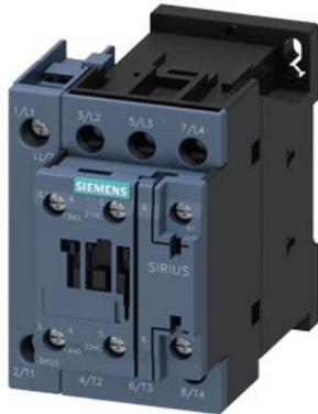
contattore di potenza, AC-3, 32 A, 15 kW / 400 V, a 4 poli, AC 230 V, 50/60 Hz, contatti ausiliari: 1 NO + 1 NC, morsetti a vite, grandezza costruttiva: S0
