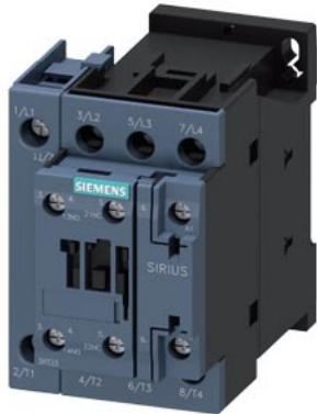
contattore AC-1, 40 A, 400 V / 40 °C, a 4 poli, AC 110 V, 50 Hz / 120 V, 60 Hz, contatti ausiliari: 1 NO + 1 NC, morsetti a vite, grandezza costruttiva: S0
