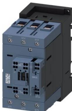
contattore di potenza, AC-3e/AC-3, 110 A, 55 kW / 400 V, a 3 poli, AC/DC 20...33 V, 50/60 Hz, con varistore integrato, contatti ausiliari: 1 NO + 1 NC, circuito principale: morsetti a vite, circuito di comando e circuito ausiliario: morsetti a molla, grandezza costruttiva: S3, con funzione di comunicazione
