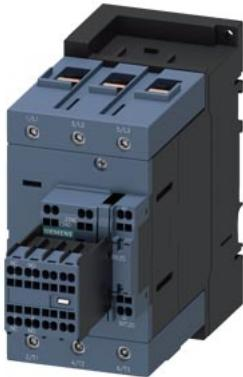
contattore ferroviario, AC-3e/AC-3, 95 A, 45 kW / 400 V, a 3 poli, DC 110 V, 0,7...1,25\* US, comando elettronico, con varistore integrato, contatti ausiliari: 2 NO + 2 NC, circuito principale: morsetti a vite, circuito di comando e circuito ausiliario: morsetti a molla, grandezza costruttiva: S3, blocchetto di contatti ausiliari rimovibile
