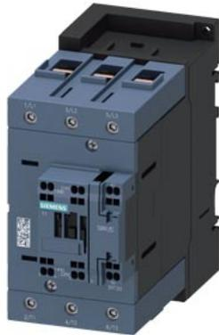
contattore di potenza, AC-3e/AC-3, 95 A, 45 kW / 400 V, a 3 poli, AC/DC 83...155 V, 50/60 Hz, con varistore integrato, contatti ausiliari: 1 NO + 1 NC, circuito principale: morsetti a vite, circuito di comando e circuito ausiliario: morsetti a molla, grandezza costruttiva: S3
