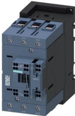
contattore di potenza, AC-3e/AC-3, 95 A, 45 kW / 400 V, a 3 poli, AC 110 V, 50 Hz, contatti ausiliari: 1 NO + 1 NC, circuito principale: morsetti a vite, circuito di comando e circuito ausiliario: morsetti a molla, grandezza costruttiva: S3
