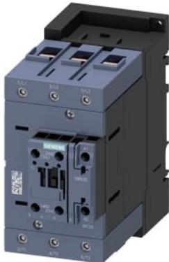
contattore di potenza, AC-3e/AC-3, 95 A, 45 kW / 400 V, a 3 poli, AC/DC 20...33 V, 50/60 Hz, con varistore integrato, contatti ausiliari: 1 NO + 1 NC, morsetti a vite, grandezza costruttiva: S3, con funzione di comunicazione
