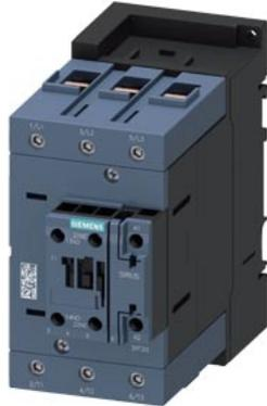
contattore di potenza, AC-3e/AC-3, 95 A, 45 kW / 400 V, a 3 poli, AC/DC 20...33 V, 50/60 Hz, con varistore integrato, contatti ausiliari: 1 NO + 1 NC, morsetti a vite, grandezza costruttiva: S3
