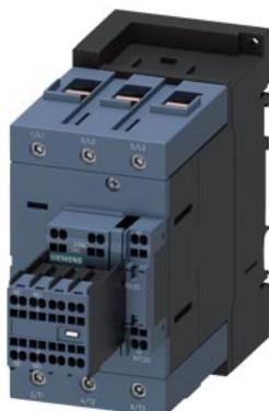
contattore ferroviario, AC-3e/AC-3, 80 A, 37 kW / 400 V, a 3 poli, DC 110 V, 0,7...1,25\* US, comando elettronico, con varistore integrato, contatti ausiliari: 1 NO + 1 NC, circuito principale: morsetti a vite, circuito di comando e circuito ausiliario: morsetti a molla, grandezza costruttiva: S3, blocchetto di contatti ausiliari rimovibile
