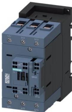
contattore di potenza, AC-3e/AC-3, 80 A, 37 kW / 400 V, a 3 poli, AC 230 V, 50 Hz, contatti ausiliari: 1 NO + 1 NC, circuito principale: morsetti a vite, circuito di comando e circuito ausiliario: morsetti a molla, grandezza costruttiva: S3
