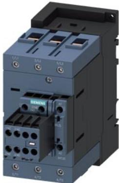
contattore di potenza, AC-3e/AC-3, 80 A, 37 kW / 400 V, a 3 poli, AC/DC 83...155 V, 50/60 Hz, con varistore integrato, contatti ausiliari: 2 NO + 2 NC, morsetti a vite, grandezza costruttiva: S3, blocchetto di contatti ausiliari rimovibile
